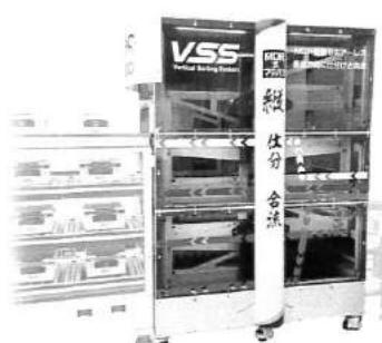
ヴァーティカルソーティングシステムは垂直方向に動作する棚部材を複数持ち、各棚部材に載せられた荷物を同時に搬送できる。二つの棚がシーソー動作で昇降を繰り返し、垂直方向に荷物を高速仕分けする装置である。
